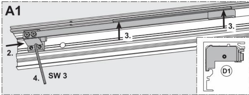
Der normale Stopper wird ersetzt durch den Stopper der Einzugsdämpfung
