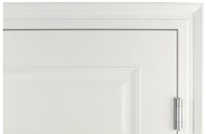
Detail TOSCANA in Schleiflack weiß (ähnlich RAL 9010) Türblatt mit echt abgeplatteter Füllung und Füllungsprofil F52, System PLANO - Türblatt flächenbündig, Zarge mit Conturbekleidung
